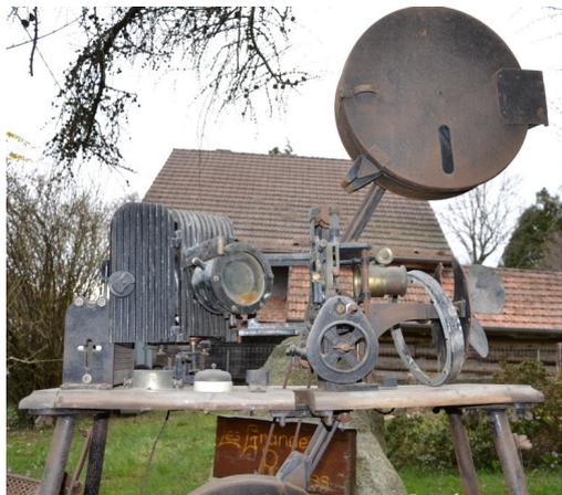
*Ce projecteur, dénommé « Le Petit Professionnel », permettait de projeter un film de 400m de longueur, sur un écran de 4m de côté à 20m de distance.*
